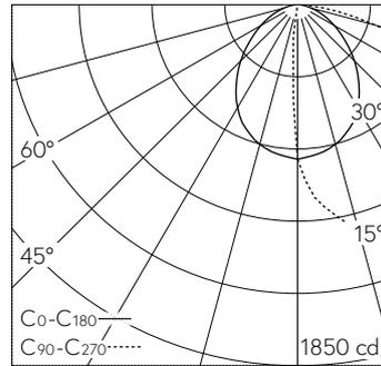
LED 4000 K 41.6 W 5177 lm-h / CIE Flux 41 78 96 100 100 / A30 selon DIN 5040
