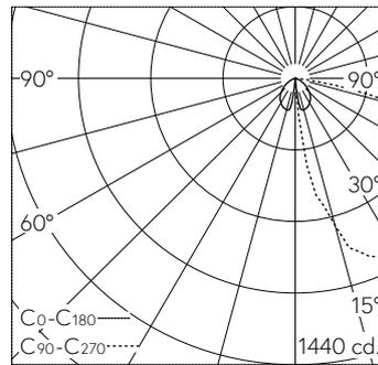
LED 3000 K 13.1 W 1694 lm-h / CIE Flux 32 71 96 100 100 / A20 selon DIN 5040
