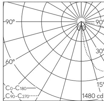
LED 4000 K 13.1 W 1743 lm-h / CIE Flux 32 71 96 100 100 / A20 selon DIN 5040
