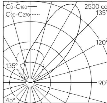
LED 4000 K 30 W 2929 lm-h / CIE Flux 0 0 0 100 / E84 selon DIN 5040
