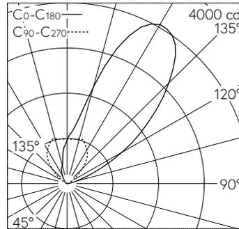
LED 3000 K 30 W 2785 lm-h / CIE Flux 0 0 17 0 100 / E84 selon DIN 5040
