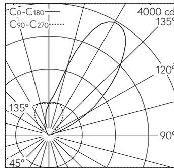
LED 2700 K 30 W 2705 lm-h / CIE Flux 0 0 17 0 100 / E84 selon DIN 5040
