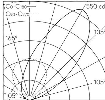
LED 4000 K 9.3 W 834 lm-h / CIE Flux 0 0 0 100 / E83 selon DIN 5040
