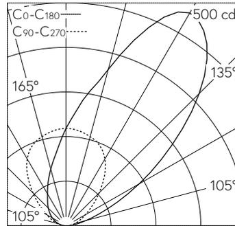
LED 3000 K 9.3 W 793 lm-h / CIE Flux 0 0 0 100 / E83 selon DIN 5040
