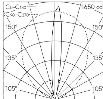
LED RGBW 0 K 17 W 608 lm-h / CIE Flux 0 0 0 100 / E84 selon DIN 5040
