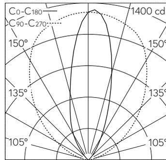
LED RGBW 0 K 28 W 1279 lm-h / CIE Flux 0 0 17 0 100 / E84 selon DIN 5040
