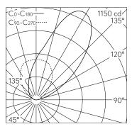
LED 3000 K 16 W 1407 lm-h / CIE Flux 0 0 0 0 100 / E84 selon DIN 5040
