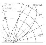
LED 3000 K 16 W 1407 lm-h / CIE Flux 0 0 0 0 100 / E84 selon DIN 5040
