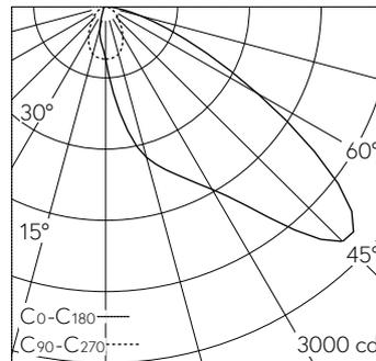
LED 4000 K 22 W 2661 lm-h / CIE Flux 39 81 97 100 100 / A30 selon DIN 5040
