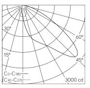
LED 4000 K 22 W 2661 lm-h / CIE Flux 39 81 97 100 100 / A30 selon DIN 5040
