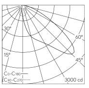
LED 3000 K 22 W 2516 lm-h / CIE Flux 39 81 97 100 100 / A30 selon DIN 5040
