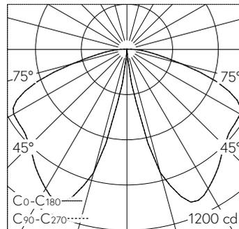
LED 4000 K 43.5 W 2716 lm-h / CIE Flux 36 68 93 99 100 / A30 selon DIN 5040
