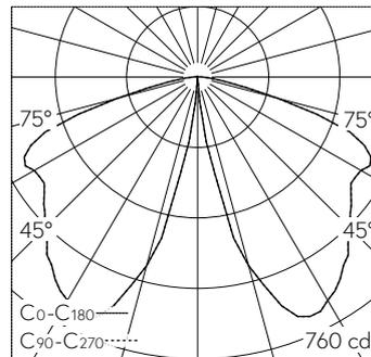
LED 3000 K 33 W 1804 lm-h / CIE Flux 38 70 95 99 100 / A30 selon DIN 5040
