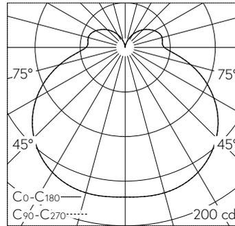
LED 3000 K 8.8 W 900 lm-h / CIE Flux 37 66 87 77 100 / B31 selon DIN 5040
