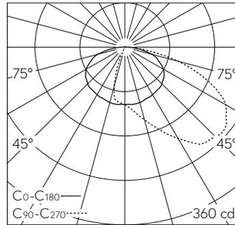
LED 4000 K 9.5 W 515 lm-h / CIE Flux 34 66 90 99 100 / A20 selon DIN 5040
