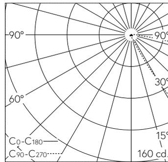
LED 3000 K 4.9 W 236 lm-h / CIE Flux 12 51 84 98 100 / A10 selon DIN 5040
