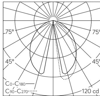
LED 3000 K 2.7 W 155 lm-h / CIE Flux 59 88 98 100 100 / A50 selon DIN 5040
