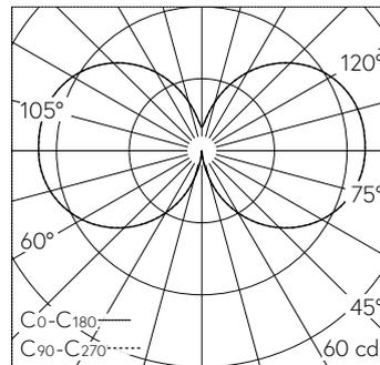
LED 3000 K 4.8 W 450 lm-h 180° / CIE Flux 13 38 66 48 100 / C11 selon DIN 5040
