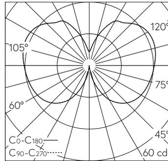
LED 3000 K 4.8 W 450 lm-h / CIE Flux 16 42 69 47 100 / C12 selon DIN 5040
