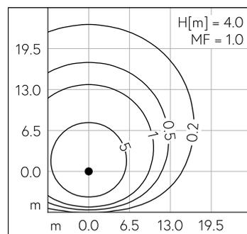
LED 4000 K 39.7 W 3212 lm-h H = 4 m / CIE Flux 41 74 93 92 100 / A31 selon DIN 5...
