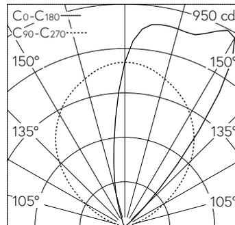
LED 4000 K 15.5 W 1114 lm-h / CIE Flux 0 0 11 0 100 / E84 selon DIN 5040
