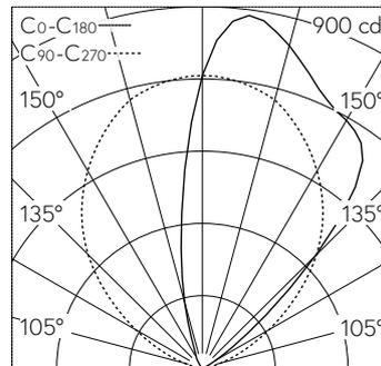
LED 3000 K 15.5 W 1083 lm-h / CIE Flux 0 0 0 100 / E84 selon DIN 5040
