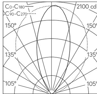
LED 3000 K 28 W 2350 lm-h / CIE Flux 0 0 3 0 100 / E84 selon DIN 5040
