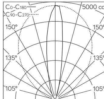
LED 3000 K 28 W 2743 lm-h / CIE Flux 0 14 14 0 100 / E84 selon DIN 5040
