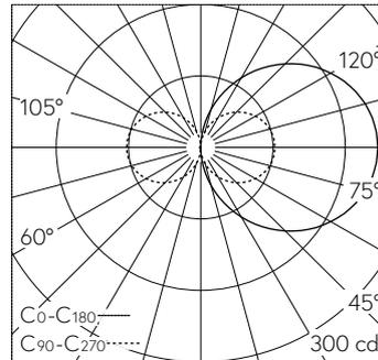
LED 2700 K 12.5 W 1084 lm-h / CIE Flux 14 38 67 50 100 / C11 selon DIN 5040
