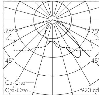
LED 4000 K 15.2 W 1615 lm-h / CIE Flux 35 73 96 100 100 / A30 selon DIN 5040
