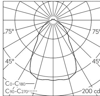
LED 4000 K 4.1 W 311 lm-h 66° / CIE Flux 63 87 96 93 100 / A51 selon DIN 5040
