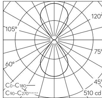
LED 3000 K 19.5 W 886 lm-h / CIE Flux 83 94 99 50 100 / C74 selon DIN 5040
