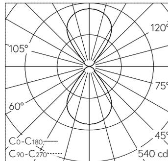
LED 3000 K 19.5 W 968 lm-h / CIE Flux 78 92 99 50 100 / C74 selon DIN 5040
