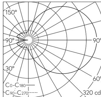
LED 2700 K 13.4 W 1161 lm-h / CIE Flux 17 42 69 50 100 / C11 selon DIN 5040
