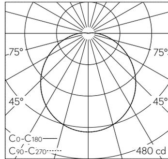
LED 3000 K 15.5 W 1182 lm-h / CIE Flux 44 74 91 98 100 / A30 selon DIN 5040
