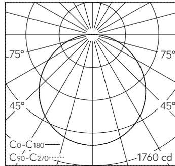
LED 3000 K 47.4 W 4467 lm-h / CIE Flux 45 76 93 99 100 / A40 selon DIN 5040
