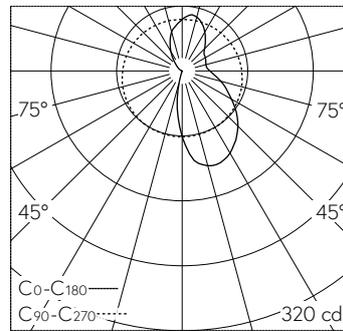
LED 3000 K 18 W 602 lm-h / CIE Flux 32 58 80 55 100 / C22 selon DIN 5040
