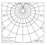
LED 3000 K 65 W 7556 lm-h / CIE Flux 25 50 75 56 100 / C12 selon DIN 5040
