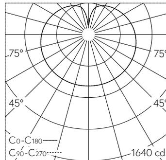
LED 4000 K 65 W 7257 lm-h / CIE Flux 26 51 75 56 100 / C22 selon DIN 5040
