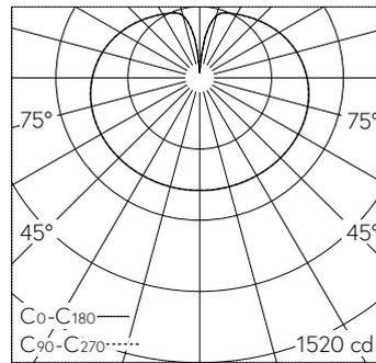
LED 4000 K 58.3 W 6716 lm-h / CIE Flux 25 51 75 56 100 / C12 selon DIN 5040
