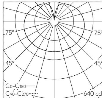
LED 3000 K 26.5 W 2868 lm-h / CIE Flux 25 50 75 56 100 / C12 selon DIN 5040
