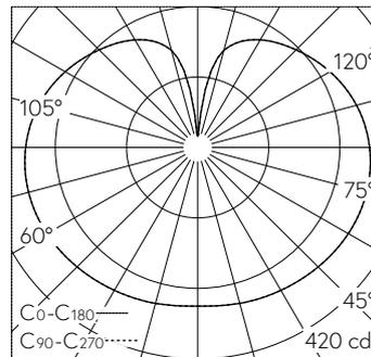
LED 3000 K 39,5 W 3949 lm-h / CIE Flux 24 49 74 54 100 / C12 selon DIN 5040
