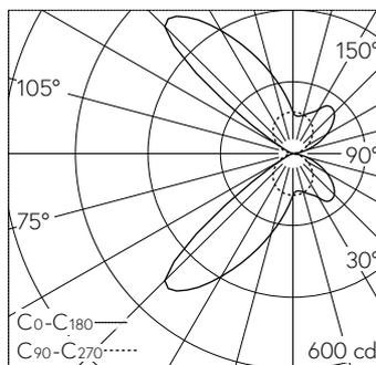
LED 3000 K 29 W 1344 lm-h / CIE Flux 43 85 98 50 100 / C43 selon DIN 5040
