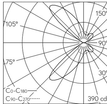
LED 3000 K 13.7 W 778 lm-h / CIE Flux 43 85 98 50 100 / C43 selon DIN 5040
