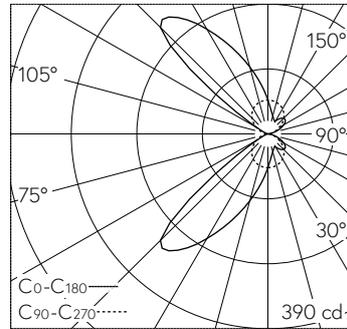
LED 3000 K 13.7 W 675 lm-h / CIE Flux 45 87 98 50 100 / C44 selon DIN 5040
