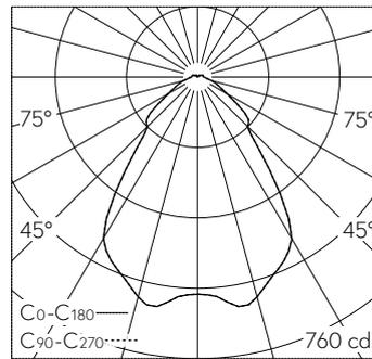
LED 3000 K 13.4 W 1178 lm-h / CIE Flux 66 88 96 95 100 / A61 selon DIN 5040
