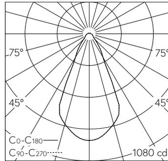
LED 3000 K 9.8 W 838 lm-h / CIE Flux 80 90 96 94 100 / A71 selon DIN 5040
