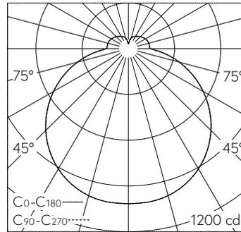
LED 3000 K 45 W 4324 lm-h / CIE Flux 40 70 89 83 100 / B31 selon DIN 5040
