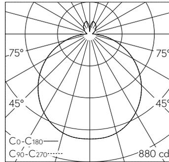
LED 3000 K 29 W 2488 lm-h / CIE Flux 45 76 93 89 100 / B43 selon DIN 5040
