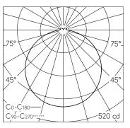
LED 3000 K 22.5 W 1427 lm-h / CIE Flux 45 76 94 93 100 / A41 selon DIN 5040
